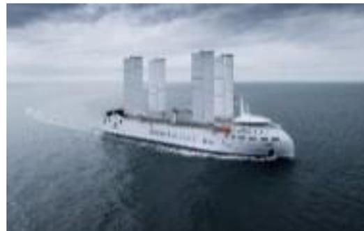
L'apparition de voiles qui sont en fait des ailes classiques est directement la conséquence de l'utilisation de matériaux composites dans l'aéronautique. Ce n'est pas l'objet de ce texte que de décrire cette dimension structurale du sujet. Quoiqu'il en soit, retenons que cette évolution a permis d'envisager un type de voile qui est en fait une aile classique d'avion.
