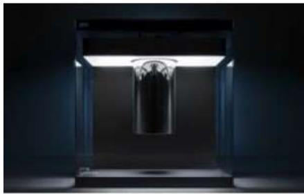
IBM Q System one, 20 qubits, technologie supraconducteur cuve en verre, 27 m3
