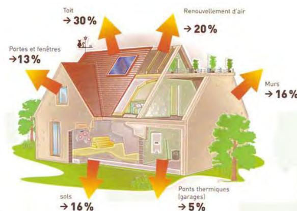
Fig. 4 – Déperdition d'énergie d'une maison d'habitation
